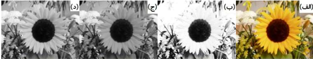
شکل ۳- روش های مختلف تبدیل تصویر رنگی به خاکستری: الف- تصویر اصلی ب- روش روشنایی ج- روش متوسط د- روش لومینانس Fig. 3 Different ways to convert RGB image to gray image: a) The original image, b) Lightness Method, c) Average method and d) Luminosity Method
